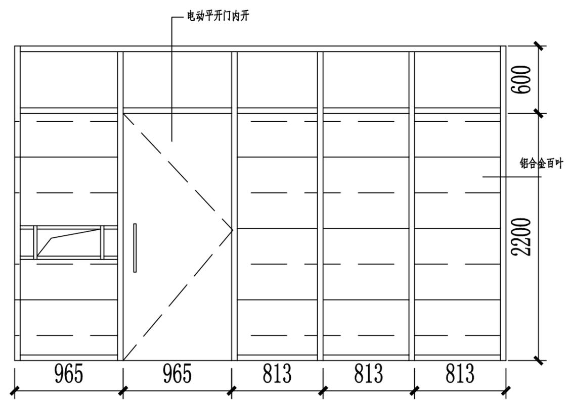
原有隔间拆除改造补部分材料加门开启电机及控制系统
